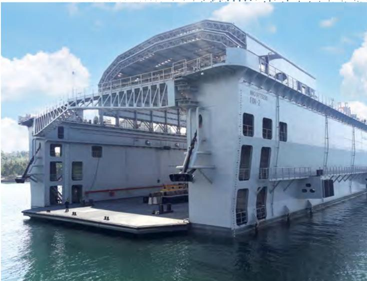
Die riesige schwimmende Werkstatt kann nicht nur Schiffe, sondern auch U-Boote zu Reparatur- und Wartungsarbeiten aufnehmen
