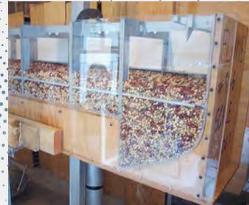
Der in den 1970er übernommene **Teststand** leistet Flume bis in die 2000er wertvolle Dienste bei der **Bestimmung von Rolldämpfung für verschiedene Tankdesigns**
