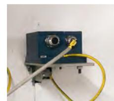
Der **HOSIM-Sensor** (Hoppe-Ship-Inertial-Measuring) liefert genaue Daten vom dynamischen Seegangverhalten des Schiffs
