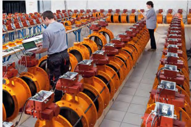
Testaufbau einer kompletten **S-Two Bus-Ventilsteuerung** in der Fertigungshalle des Betriebs in Lage
