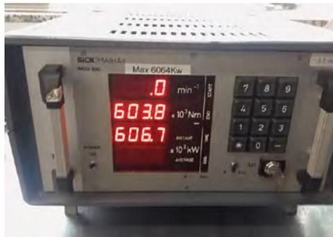
Die Sensorik der **MAIHAK Leistungs-messanlage** ist bis heute fast unverändert. Die Steuerungselektronik und Anzeige hingegen blieb nicht lange auf dem hier gezeigten Stand
