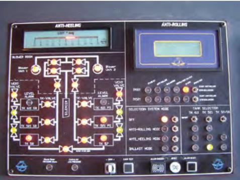
Steuerungskonsole und Gebläseeinheit des ersten Anti-Heeling-Blower-Systems von Hoppe auf der BOA SUB C
